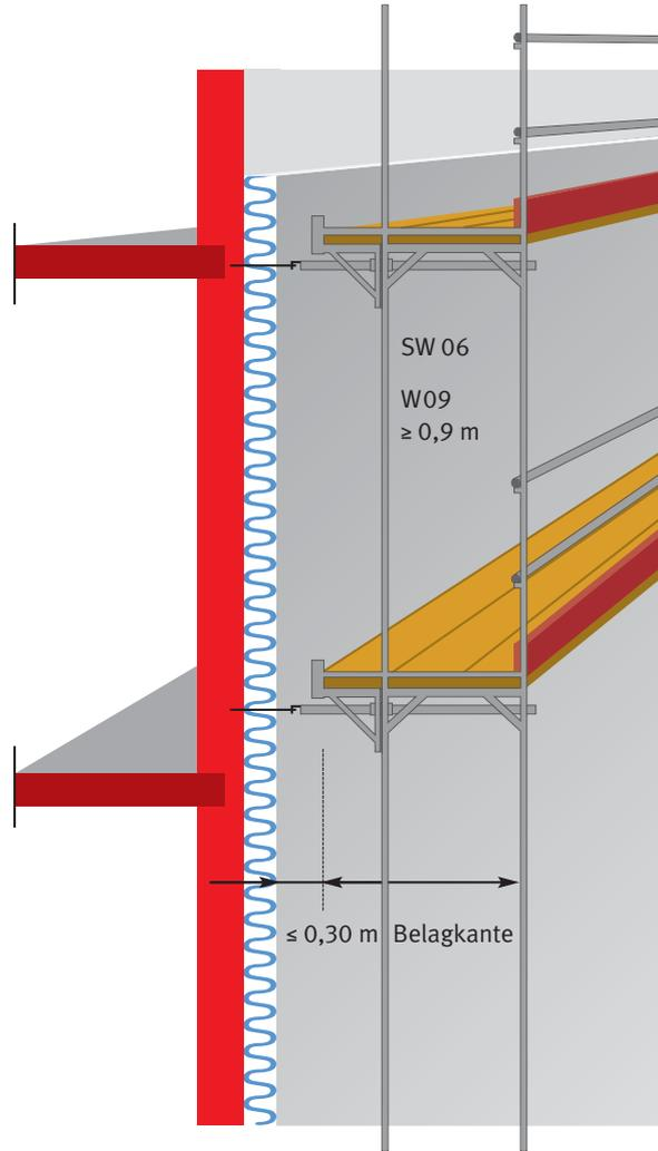
Bild 2: Gerüst SW 06 mit Konsole 0,30 m
