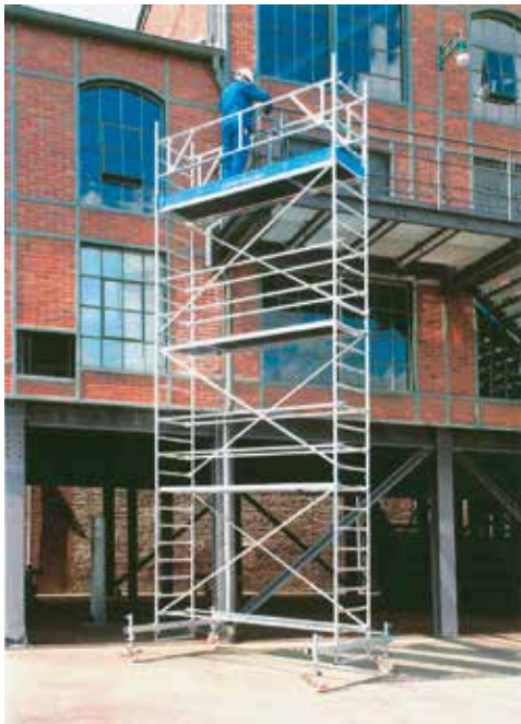
Bild 14: Beispiel für fahrbare Arbeitsbühne
