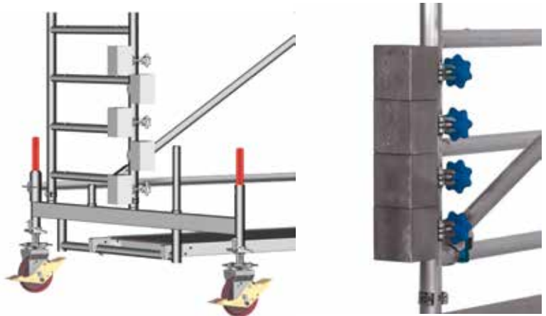
Bild 7: Beispiele für die Befestigung von Ballastkörpern mit Halbkupplungen
