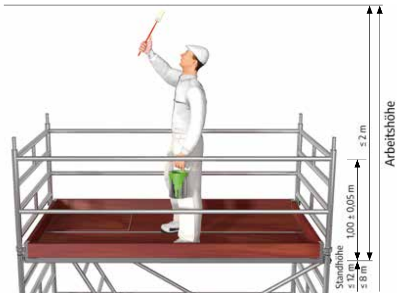
Bild 1: Standhöhe und Arbeitshöhe von Fahrgerüsten
